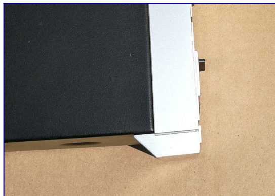
Obudowa z dokładanymi "boczkami".
