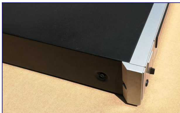
Obudowa z dokładanymi "boczkami".
