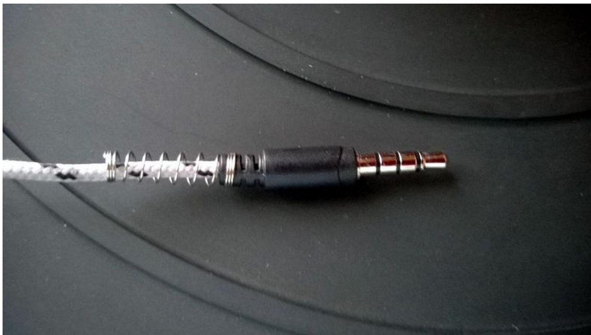
Zmodernizowana przy pomocy sprężynki wtyczka.
